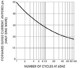
Fig. 3-MAXIMUM OVERLOAD SURGE-CURRENT
