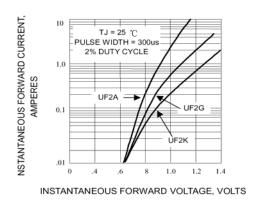
Fig. 2-TYPICAL FORWARD CHARACTERISTICS PER ELEMENT
