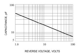
Fig. 5-TYPICAL JUNCTION CAPACITANCE PER BRIDGE ELEMENT
